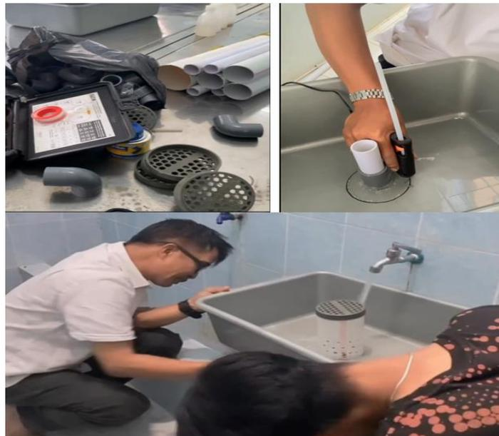
Gambar 3. Proses Instalasi dan uji kerja Bell-Siphon pada rangkaian Hidroponik
